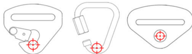
Beispiele von Anlenkpunkten der Gurtbefestigung
